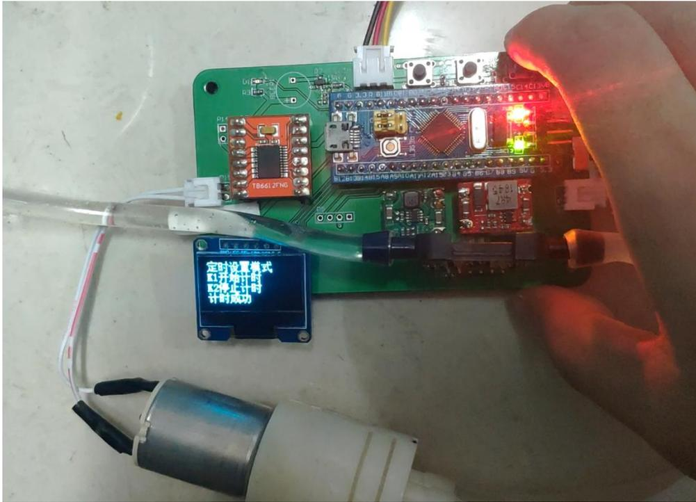
非首次启动时，不需要重复设置模式，因为会自动的进入日常使用模式，自动检测并显示土壤湿度值和电池电量值，若不需要浇灌，屏幕显示三秒之后会自动进入FreeRTOS的低功耗模式，OLED显示屏会进入熄灭状态，流量传感器FS2012会关闭，水泵与电机驱动也将关闭，整个系统进入低功耗模式，等待定时时间到或等待WK\_UP按键被按下唤醒系统进行检测。
